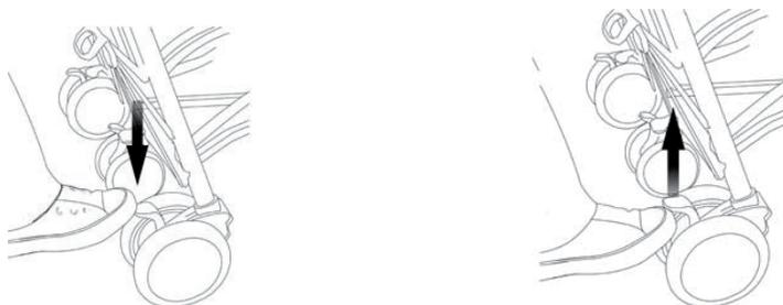
**SE** A. Vagnen är försedd med bromsar på de bakre hjulen. För att bromsa så trycker ni ner foten försiktigt och gungar vagnen lite så att bromsen hoppar i läge. Bild A.
